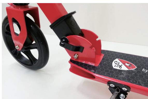
④前輪タイヤ左側クイックレバーを倒し、ロックします。
