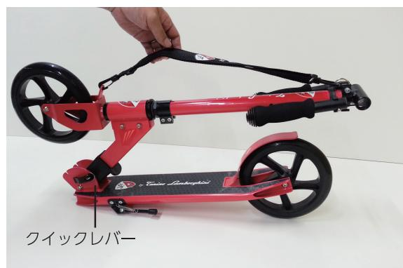
③前輪タイヤ左側クイックレバーを倒しロックします。
