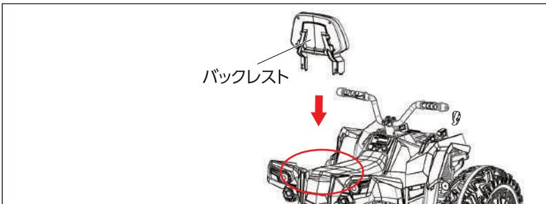
座面にある2つの溝に、バックレストをしっかりと差し込みます。
