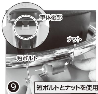
⑨バッテリーの上にシートをかぶせ、「短ボルト」と「ナット」を使用し、ドライバーでしっかりと締め付けシートを固定します。
